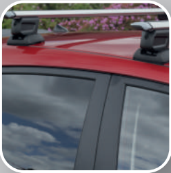
Travesaños de techo
